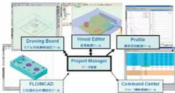
図2 FLOTHERMのシステム構成
