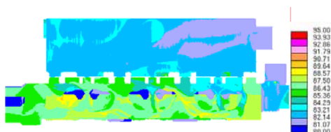
图 15 方案 C 缸盖温度场
