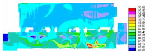
图7 原方案水套温度场 ( T_{\max}=98^{\circ}\text{C} )
