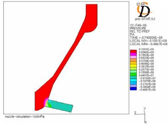
图10 针阀升程  $h=0.273\text{mm}$  时的压力云图
