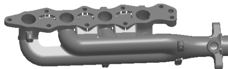
图 15 优化后状态排气歧管
