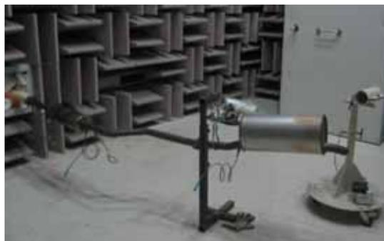
图 13 排气系统尾管噪声台架测试
