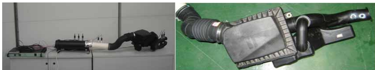
图 7：某进气系统传递损失测试图
