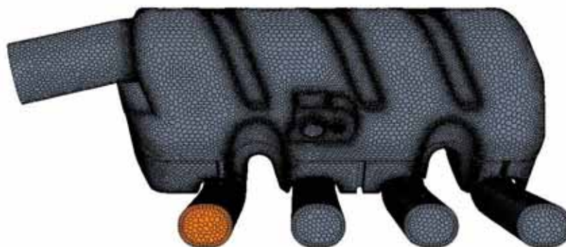
图 7 改进后进气歧管体网格示意图
