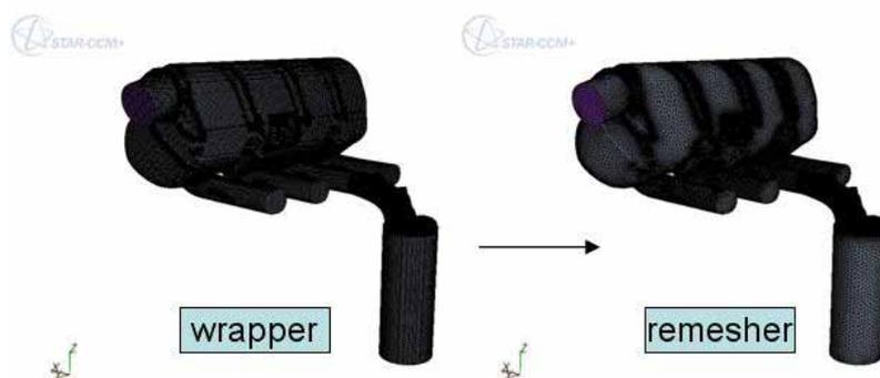
图 2 耦合模型面网格
