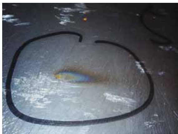
图 1. ALSTOM 机组 11F 活动导叶负压面浸蚀区域 图 2. VGS 机组 9F 活动导叶浸蚀部位高温现象
