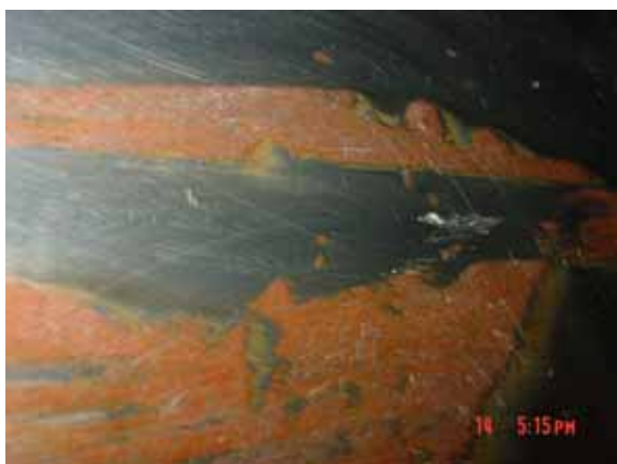
图 1. ALSTOM 机组 11F 活动导叶负压面浸蚀区域 图 2. VGS 机组 9F 活动导叶浸蚀部位高温现象
