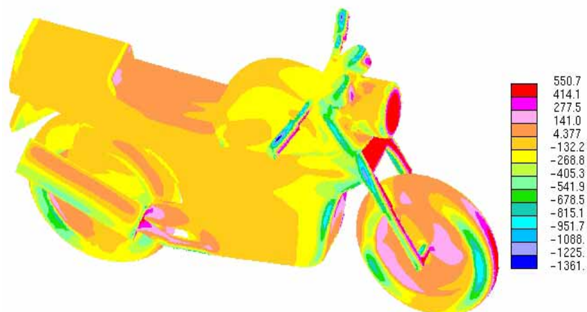
图五 摩托车表面压力分布
