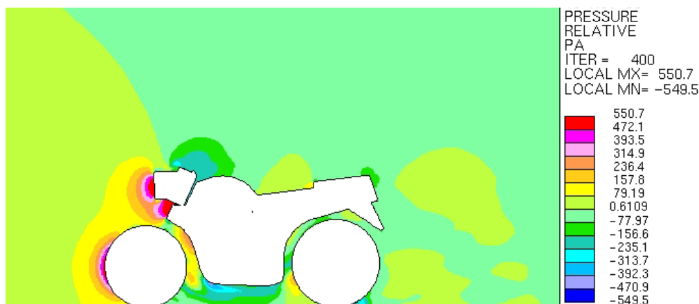
图八 摩托车的中央截面压力图
