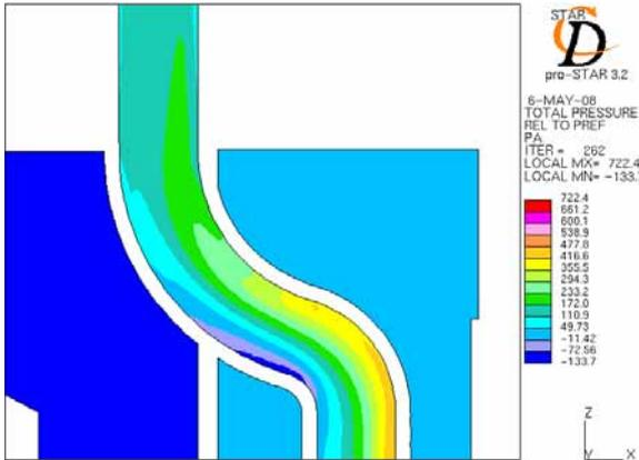
图 6 改进后的管道内的压力变化
