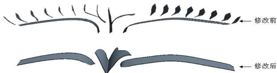
图 6 除霜风道内部扰流板修改前后对比图
