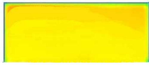
图 2 Y=15m 处横截面温度分布图
