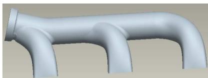
图1 排气管实体模型
