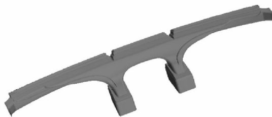
图 2.2 空调除霜风道模型
