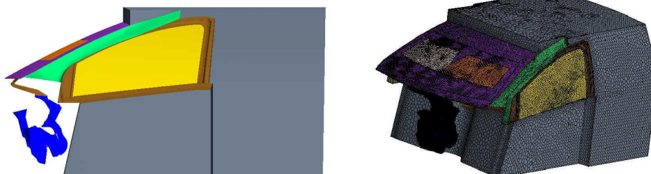
图 3 乘员舱及除霜风管几何外形
