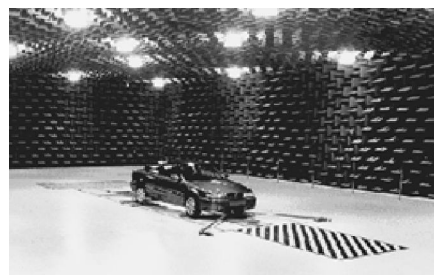
图5 整车车内噪声试验
