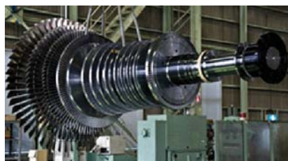
図2 タービンローター(新日本造機様 Webサイトより抜粋)
