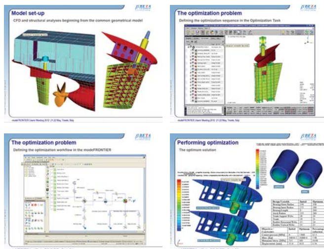
図12 運搬船のラダーの形状最適化
