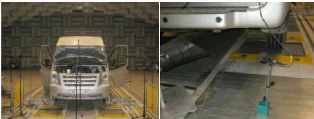
图 12 排气系统尾管噪声测试
