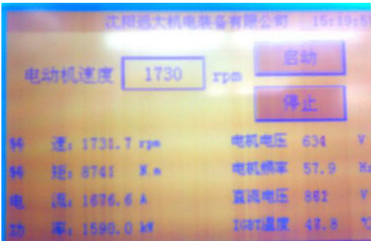
图 14 驱动端量表显示发电机已在额定转速下运行
