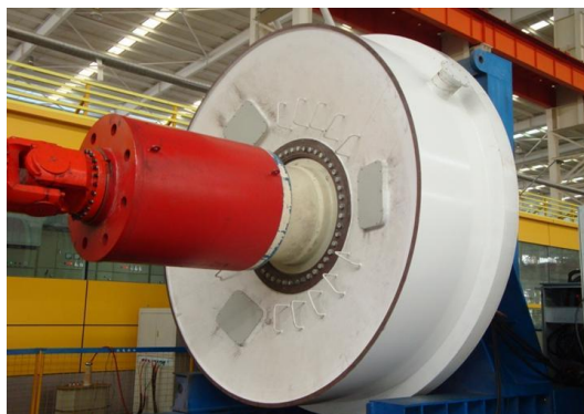
图 13 外转子永磁风力发电机样机照片
