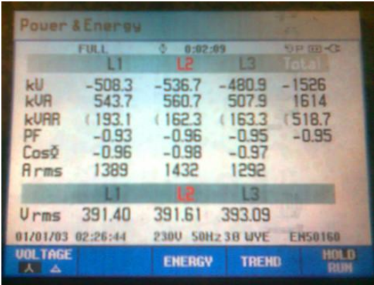
图 16 功率表采集的发电机主要性能参数的数值显示
