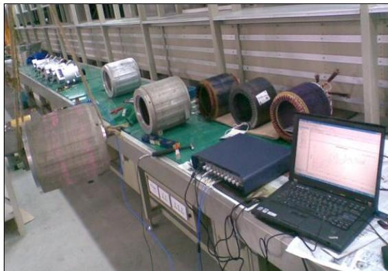
图 4 电机结构部件及整机模态实验
