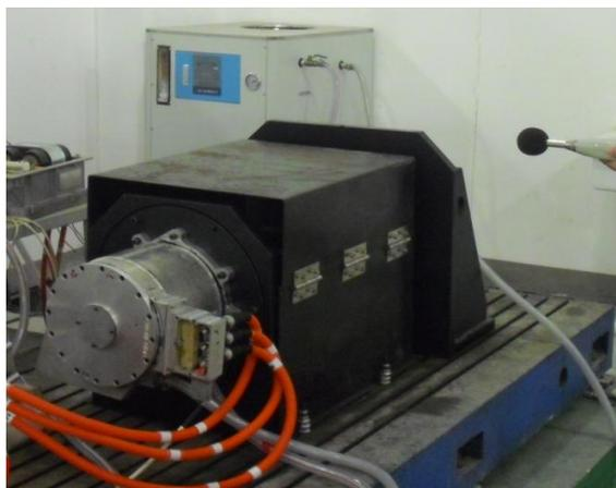
图 7 样机噪声测试实验图
