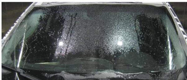
图 1 除霜过程中前风挡融冰照片
