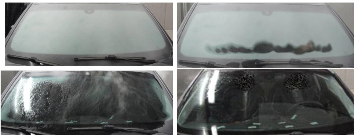
图 19 除霜试验照片
