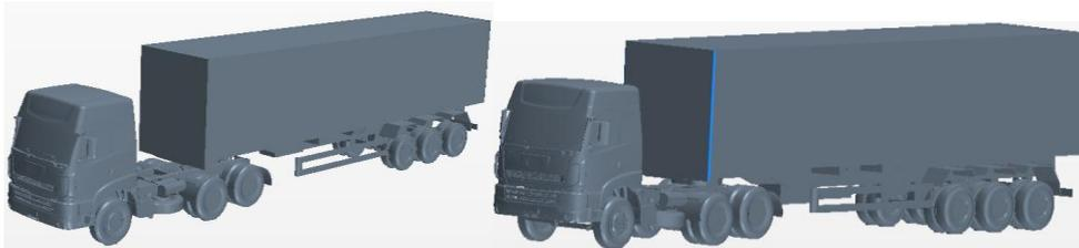
模型 1 原始模型模型 2 集装箱前端左右两侧边倒圆角
