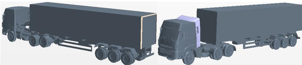
模型 3 安装尾部加长板模型 4 驾驶室安装顶部导流罩及侧导流罩
