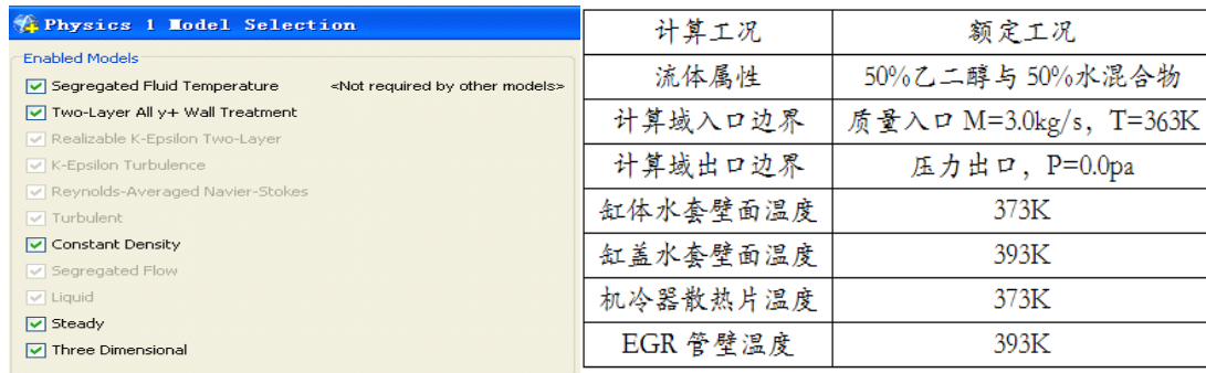
图 02 CFD 物理模型选择及边界条件设置
