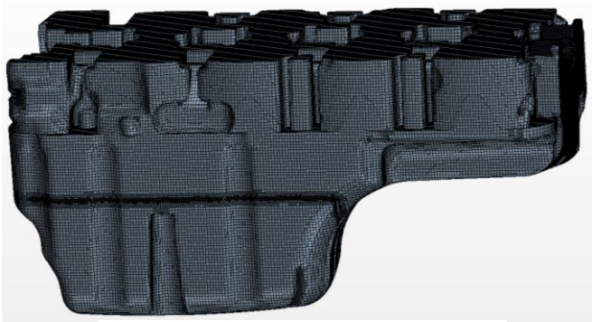
图 3 优化后油底壳系统体网格
