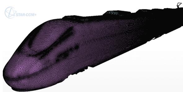
图 3 网格重构后的模型
