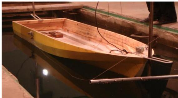
图 3.1 滑艇船模在水池静止状态
