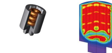
通过内置感应加热绕组的方式对凹面物体进行感应加热。
