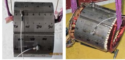
图8 定子无绕组和有绕组模态试验时的自由悬挂图
