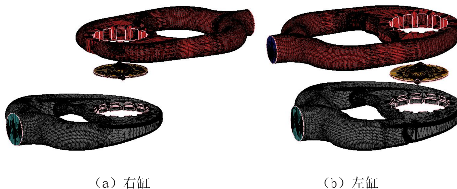
图 5 发动机 Converge 计算模型
