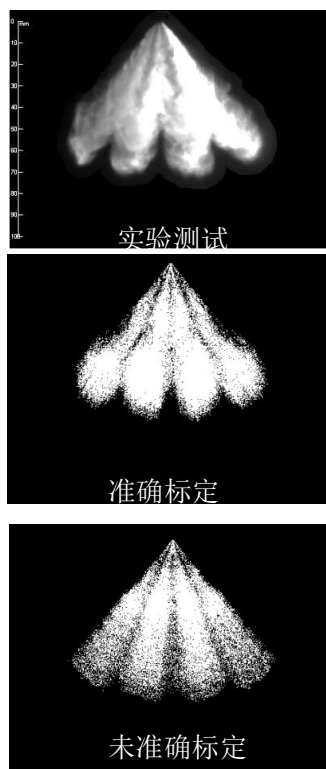
图9 实验测试、已准确标定和未准确标定的喷雾宏观形态对比
