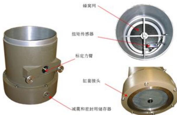
图 16 涡流测量装置示意图
