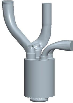
图 1 气道及燃烧室三维模型
