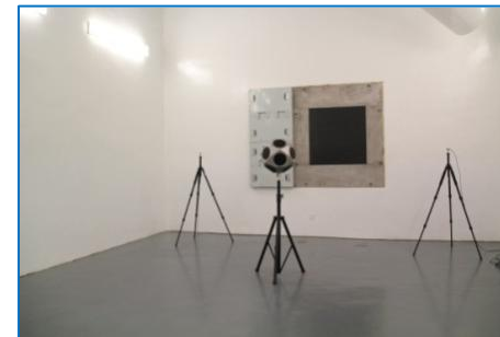
混响试验室 Reverberation lab
