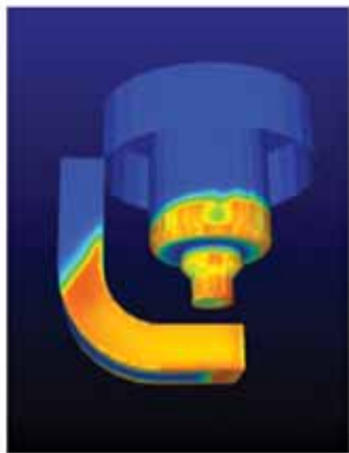
CHT计算可以获得更真实的表面温度分布，从而提高模拟的精度
