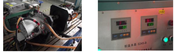
图 8 样机温升试验平台实物照片
