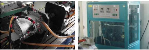
图 9 样机温升试验平台 Fig. 9 Temperature test platform of prototype machine
