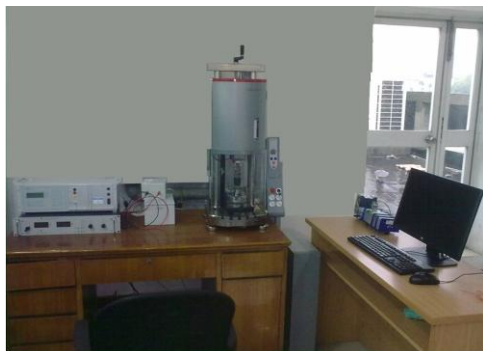
图 6 静态电磁力测试装置
