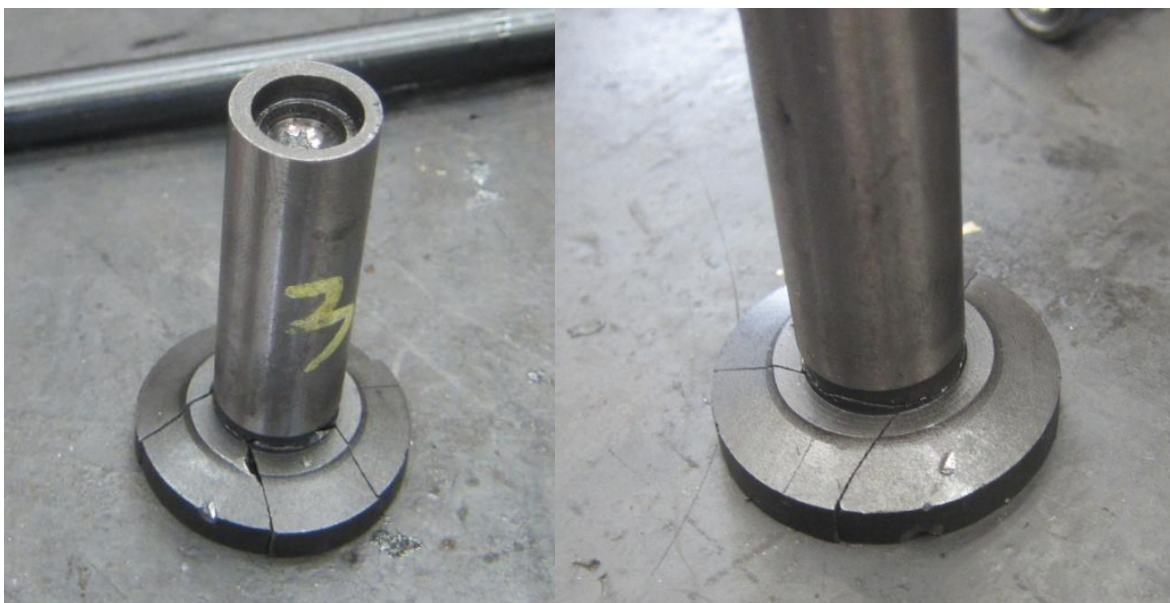
图 1 挺柱断裂图片
