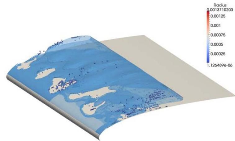
图 汽蚀计算 (By Håkan Nilsson)
