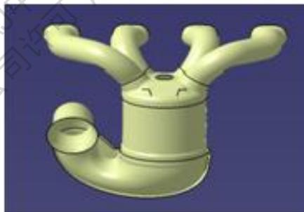
图 7 原机排气歧管
