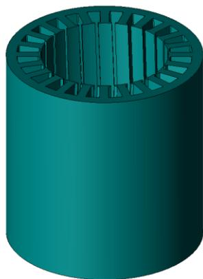
图 13 斜槽角为  $6^\circ$  的定子铁芯 3D 模型
