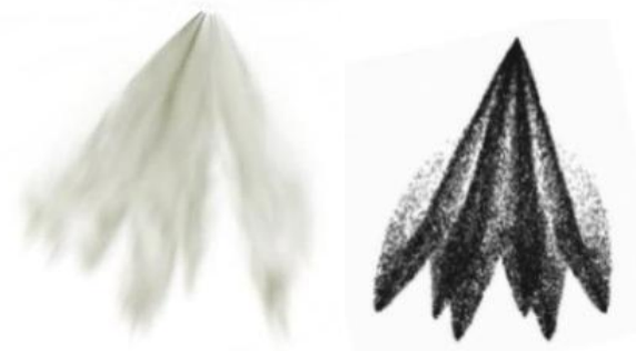
图 5 喷雾型态与模拟喷雾型态
