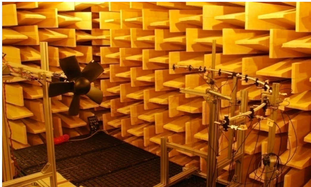
在消音室内进行声学测量
