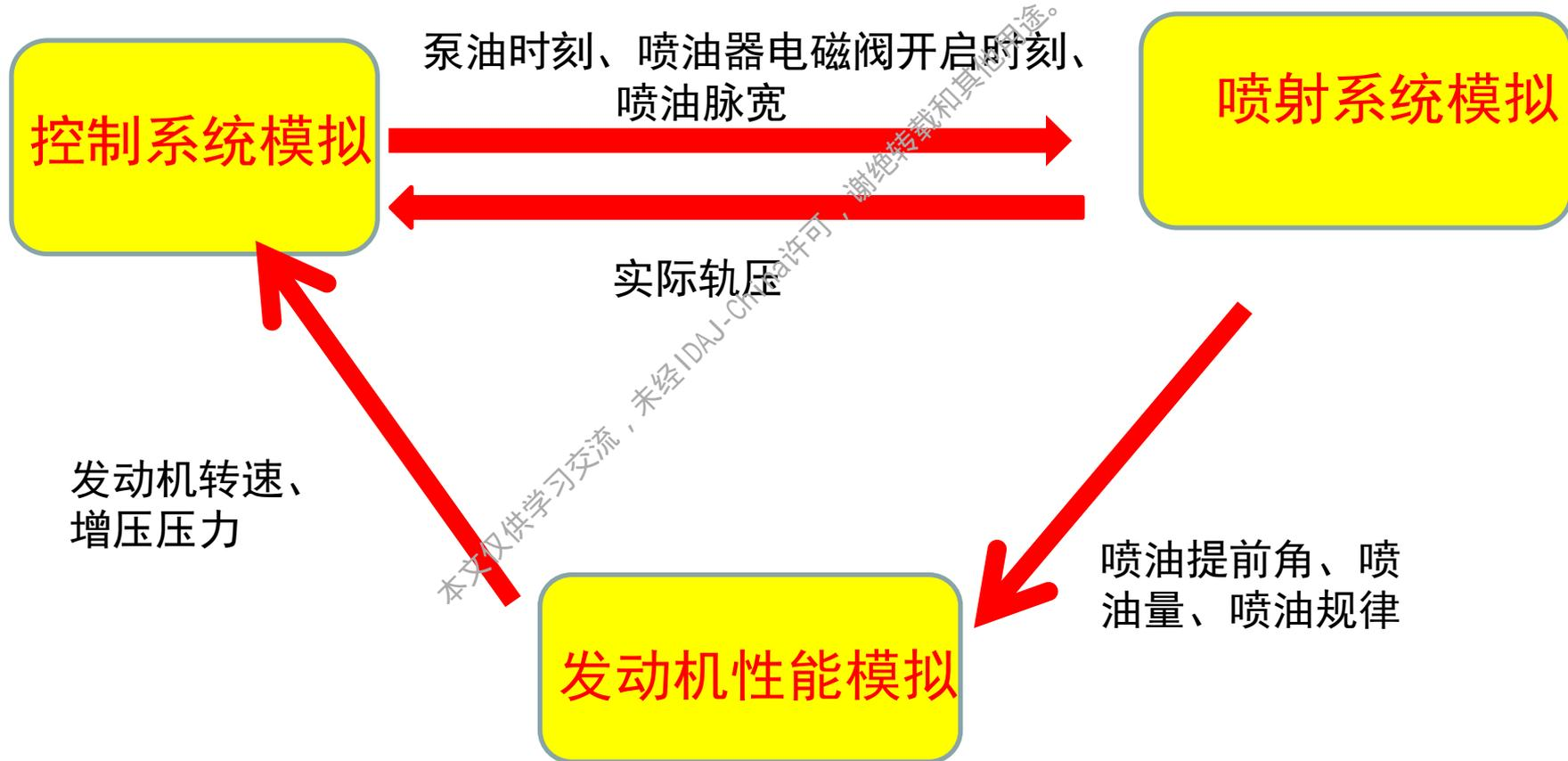
供油系统、发动机性能和控制系统三者之间的关系
