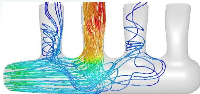
根据原方案2缸的分析结果，对进气歧管进行改进仍需要多次优化，无法量化反馈给设计工程师。
