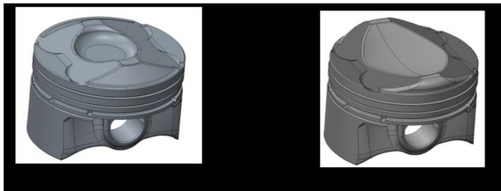
图 4 原型机与升级机型活塞形状对比示意
