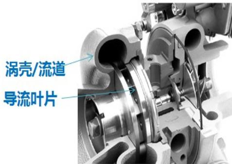
图 1 VGT 增压器结构
