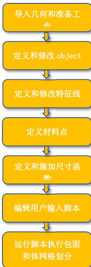
图3 脚本化网格流程
