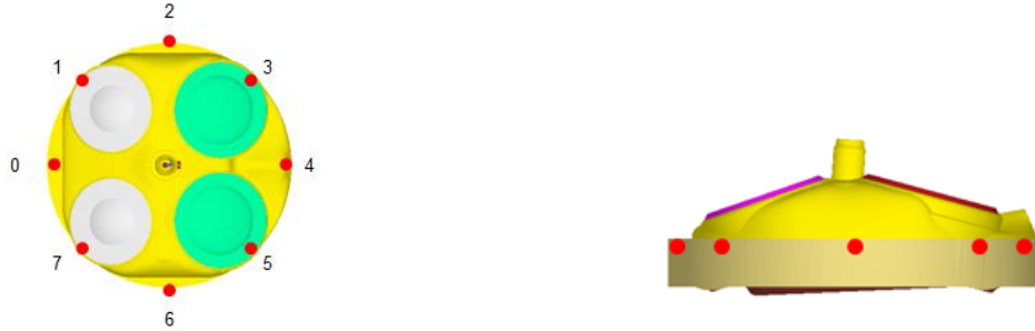
图 8 缸内监测点的布置
