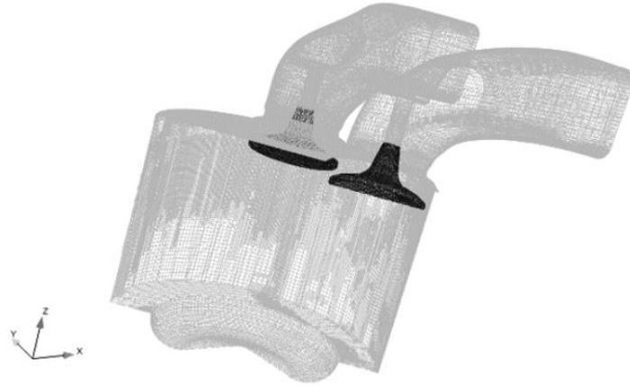
图 6 单缸柴油机进气过程模型网格
