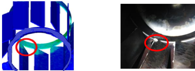
图5 实验结果与仿真结果结晶位置对比图
